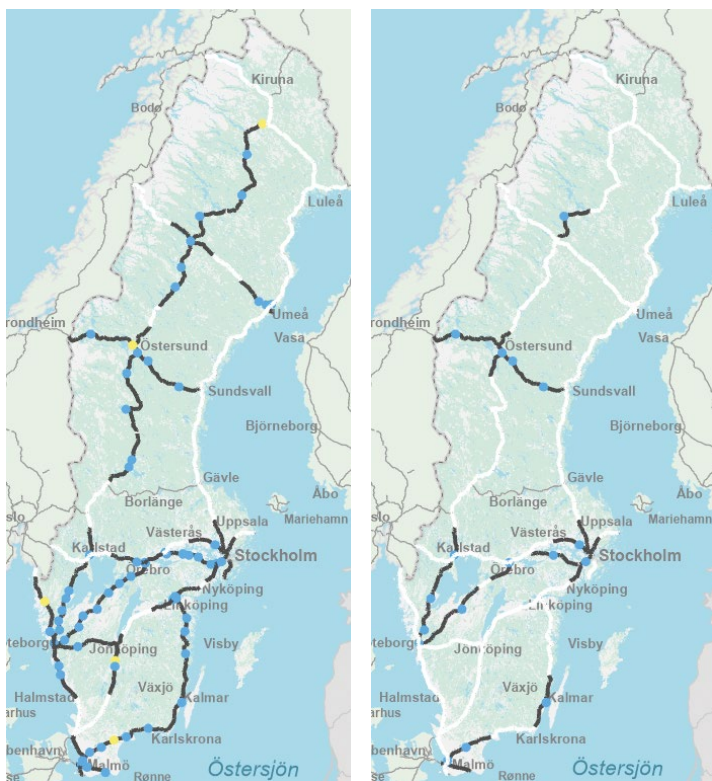
Figur 13. Delar av TEN-T stomvägnät som bedöms vara täckt av laddningspooler som uppfyller AFIR:s krav för 2027 för tunga fordon.
