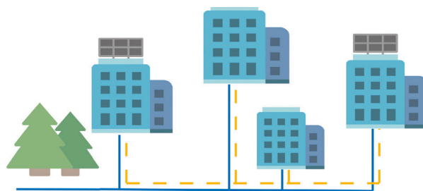
Figur 4. Delning i befintligt nät, så kallad virtuell delning.
