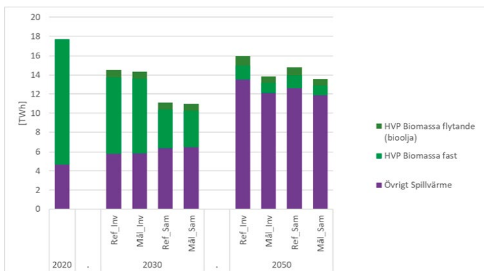
Figur 45. Förnybar fjärrvärme från hetvattenpanna (HVP) samt industriell spillvärme.
