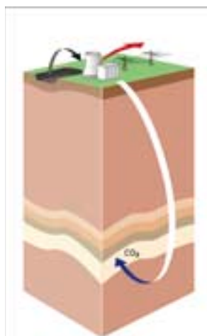
CCS-tekniken i genomskärning: koldioxiden avskiljs i förbränningsprocessen i kraftverket och injekteras sedan långt under markytan, antingen i befintliga gas- och oljefält eller i akvifärer, det vill säga geologiska formationer som innehåller saltvatten.
