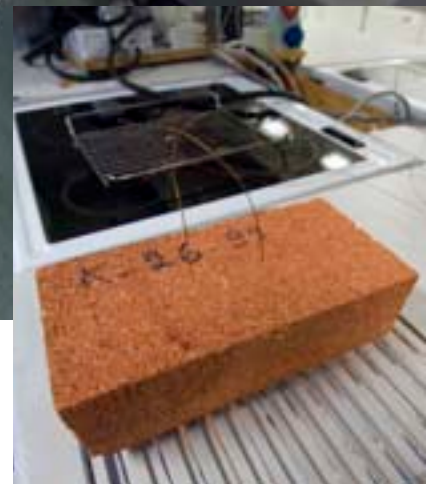
Energiförbrukningen i ugnar mäts med hjälp av ett block i isolermaterial.
