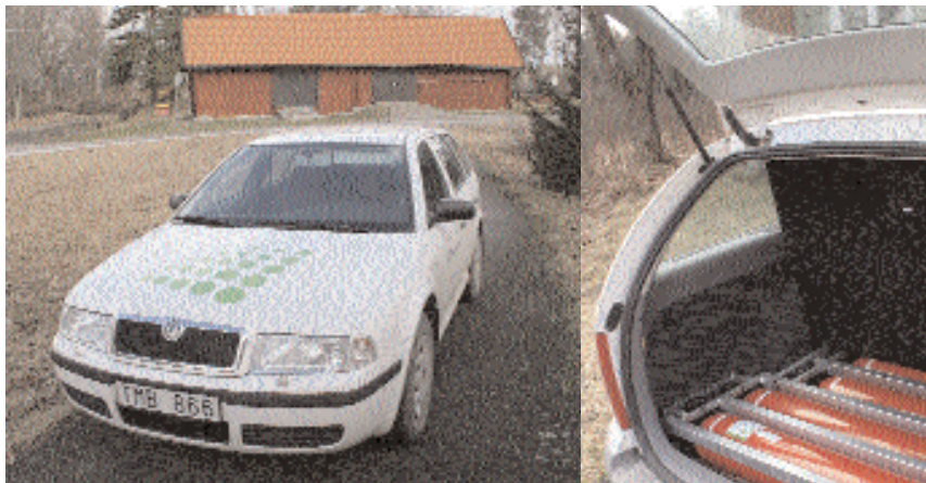
Skoda Octavia 1,6 är först ut som godkänd, biogaskonverterad personbil. I bagaget finns en 92 liters gastank. Dessutom finns den vanliga bensintanken på 55 liter kvar.
