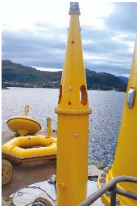
Vågkraftsaggregaten är sju meter höga och placeras på havsbotten.
