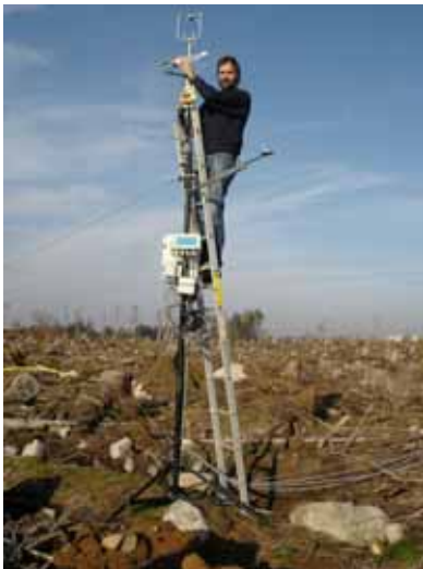
Figur 6:2 Eddy-flux-mätningar på en stormfälld yta i Toftaholm
