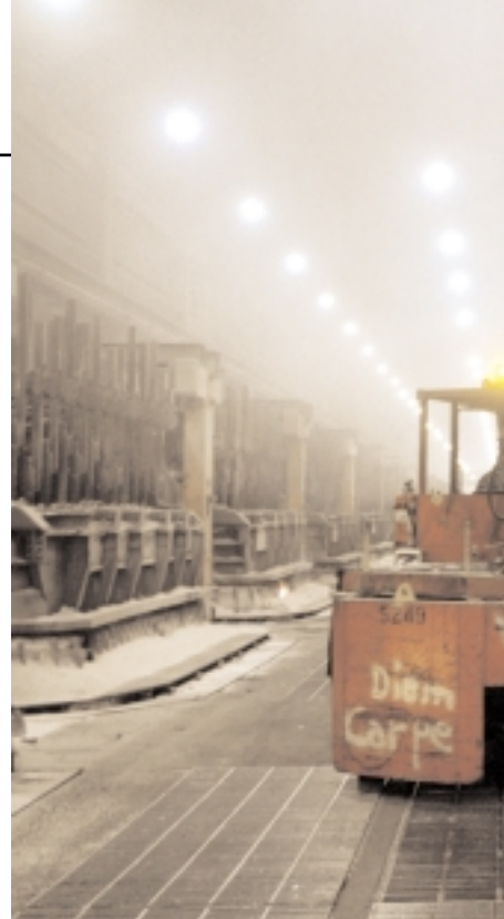
Smältan har sugits upp ur ugnen och töms över i en c
