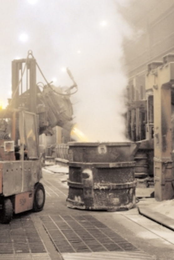
kontainer för att fraktas till stränggjutningen.
