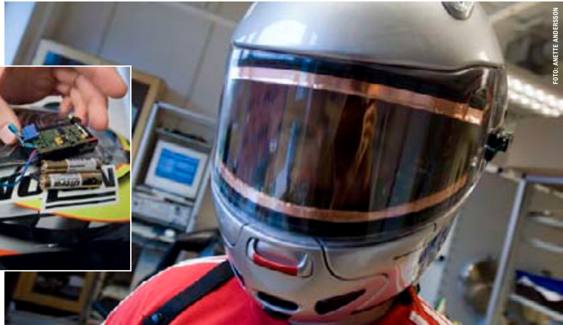
MC-visir som reglerar ljusinflödet med hjälp av elektriskt ledande skikt är första steget mot smarta fönster. Strömmen kommer från två batterier.
