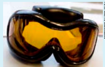
En elektrokrom platsfolie har lagts direkt på glaset.
