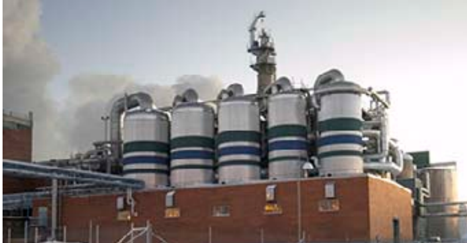
Ett konkret resultat från energiforskningen: i pilotanläggningen i Piteå tillverkas framtidens biobränsle av resterna från pappersmassan.
