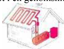
Figur 6. Solfångarsystem i villa. Källa: Norrköpings kommun.
