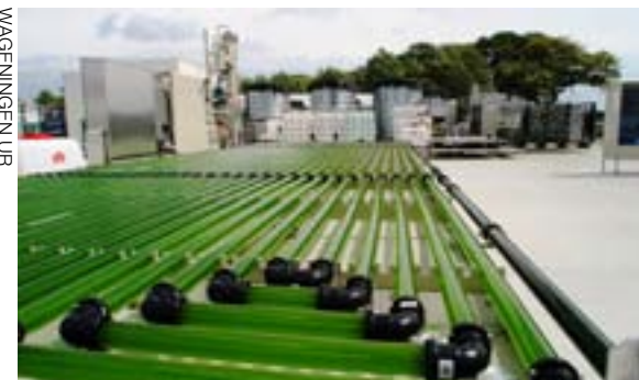
I AlgaePARC:s anläggningar i holländska Wageningen finslipar tekiken för odling av mikroalger i fotobioreaktorer.
