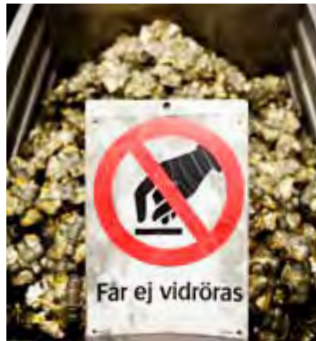
De nyligen varm-pressade ventilhusen är över 500 grader vilket bidrar till att värmen i lokalen blir förhöjd.
