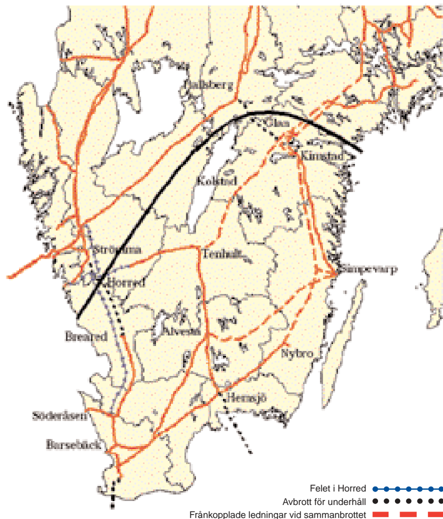
Den tjocka svarta linjen markerar det område som blev strömlöst efter att ledningarna frånkopplats. (Sv Kraftnät)
