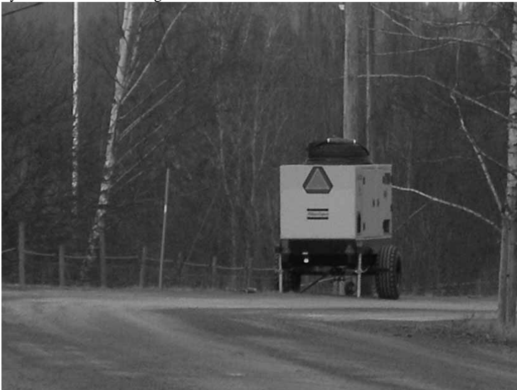
Ett aggregat i ö-drift i Stojby utanför Växjö. Foto: Växjö Kommun
