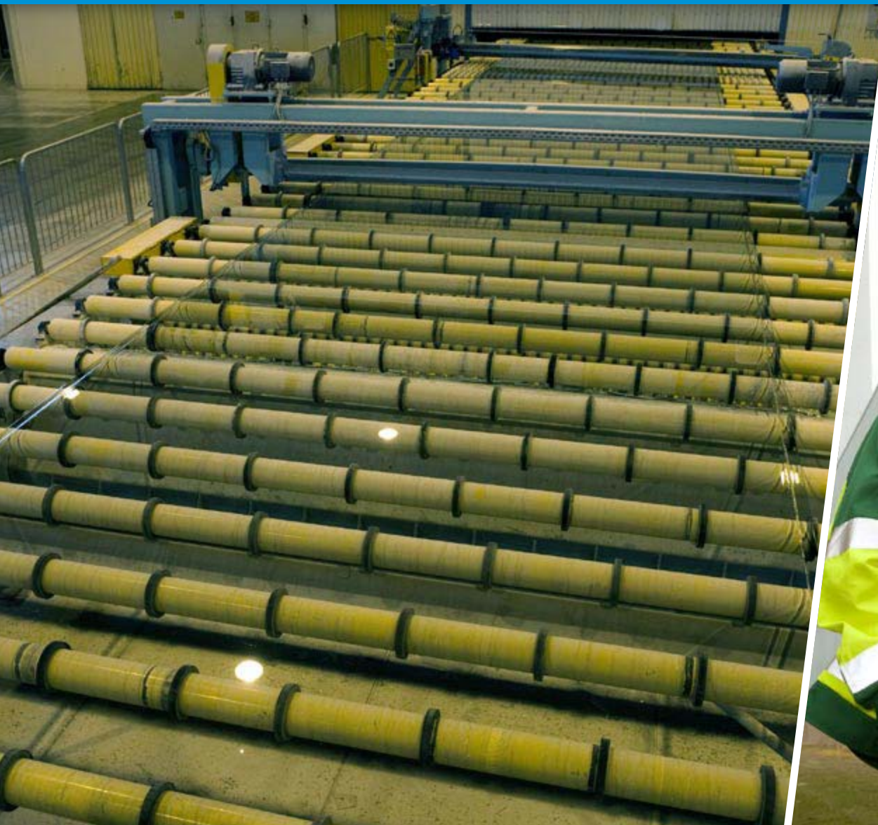
I en enda lång sträng pressas glaset över den 140 meter långa banan sedan det lämnat ugnen. Till höger: Lars Andersson, miljöansvarig på Pilkingtons Floatglas.
