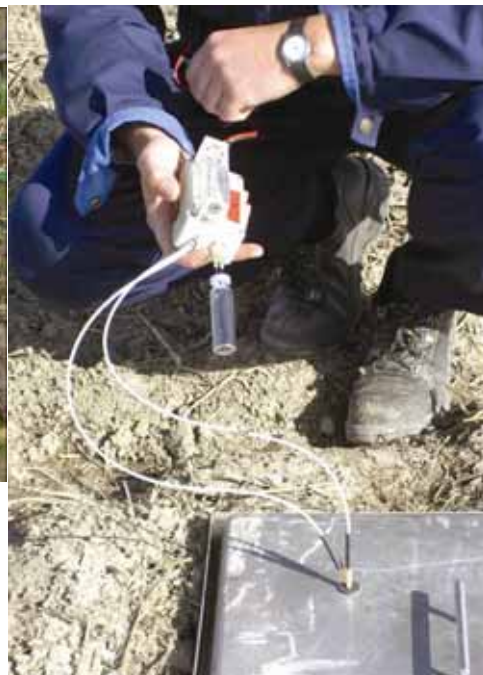
Uppsamling av gas från fältkammare på en åker.
