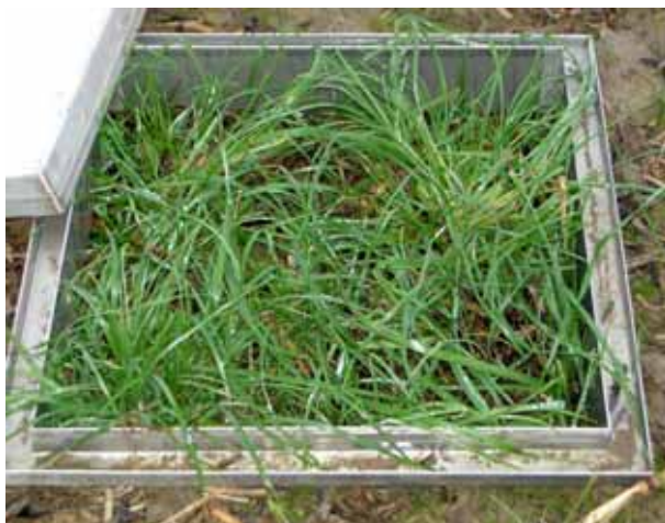
Uppsamling av gas från fältkammare på en åker.
