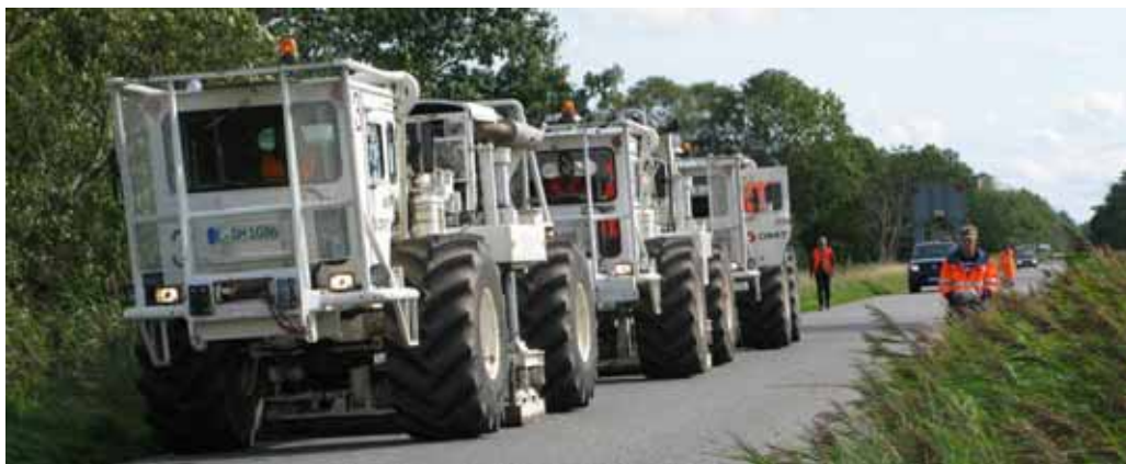
Figur 5.2 Fordon med vibratorer för 2D-seismiska undersökningar, här i Vedstedområdet hösten 2008.
