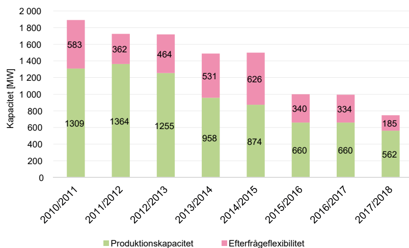
Figur 46. Upphandlad effektreserv vintrarna 2010/2011–2017/2018, MW.
