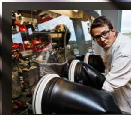
Med händerna inne i det syrefria glasskåpet på Ångströmlaboratoriet tillverkar doktoranden Fredrik Lindgren ett mikrobatteri i en foliepåse.
